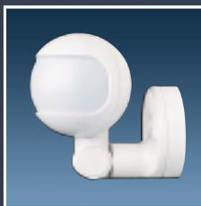
Он может вращаться во всех направлениях. Обладая углом обзора 110° и максимальной дальностью 16 м, он контролирует область, включающую 18 зон, которые расположены в трех плоскостях. Встроенные датчики сумерек, возможность установки непрерывного ночного и дневного режима работы являются частью прогрессивной технологии.
