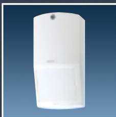
домов порядной застройки. Обладая углом обзора 70° и дальностью 8 м, он контролирует зону шириной 11 м. Пять уровней наблюдения гарантируют высокую функциональную надежность. Имеются прочные брызгозащищенные датчики в белом и антрацитовом исполнении с линзами соответствующего цвета.
