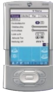
Модуль связи «BT-Gateway» от «JUNG» может управлять 8 приборами связи и выполнять функции коммутации, диммирования (плавного регулирования уровня освещенности), управления жалюзи, задания параметров, запоминания и отмены световых сцен, индикации даты, времени и т. д. Эта система идеально подходит потребителям, не имеющим специальных знаний, так как она оснащена компьютерной программой, которая сама объясняет, как ею пользоваться.
