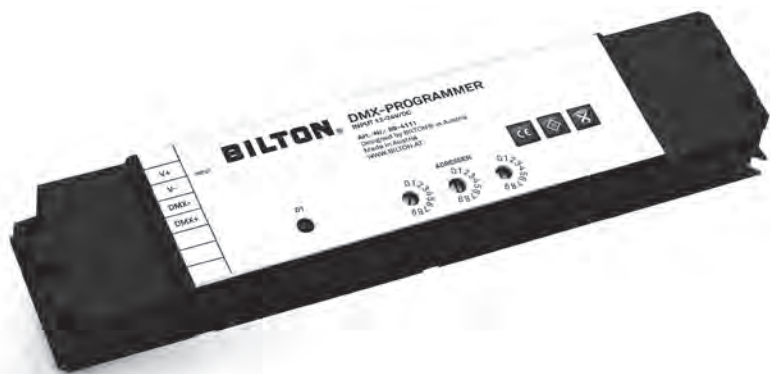
89-4111 | DMX Programmer zum Adressieren von DMX Adressen. Über Drehregler werden die Adressen eingestellt. Durch drücken der D1 Taste wird die Adresse eingespielt.
