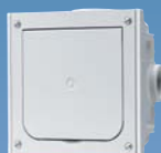
Пустой корпус для установки в пол Для монтажа компьютерных и телефонных розеток Нижняя часть – термопласт, 4 кабельных ввода PG 16, верхняя часть – крышка из алюминия с напылением краски Степень защиты – IP 41 крышка серого цвета 1632
