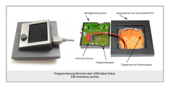
Das EIB-Kabel wird von unten mit einer Wago-Klemme direkt auf die Platine gesteckt. Das Display kann anschließend mit dem passenden Einfachrahmen auf die Dose eingerastet werden.
