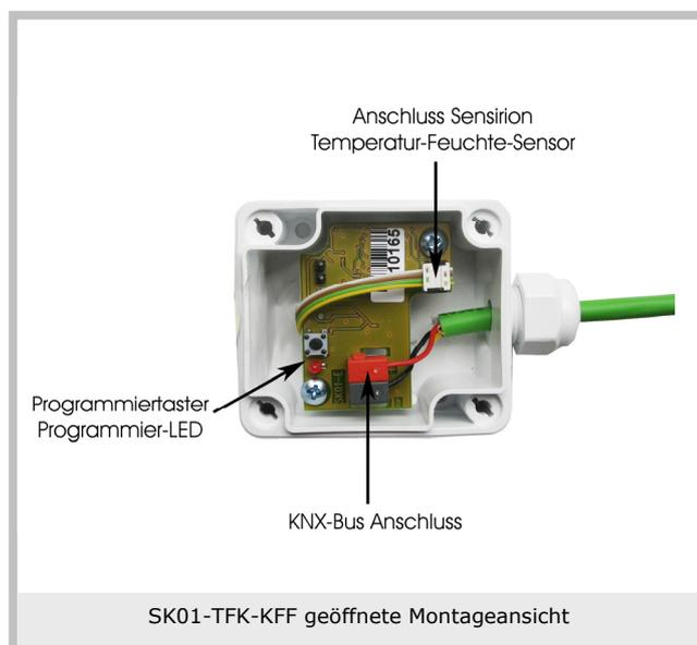
Der Deckel wird durch Drehen der Befestigungsschrauben um 90° gelöst.
