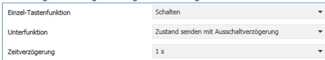
Abbildung 14: Einzel-Tastenfunktion Schalten - Zustand senden mit Ausschaltverzögerung
